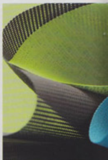
Vue du tissu microaéré Soltis de la marque Serge Ferrari, une membrane composite (PVC, polyester) fabriquée par soudure haute fréquence.
